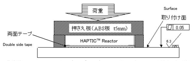
推奨材料:ステンレス、アルミニウム、ガラス、ポリカーボネート、その他上記貼り付け面寸法を保証できる材料。 Recommended materials: Stainless steel, aluminum, glass, polycarbonate, etc. which is warrantable dimension of surface.
